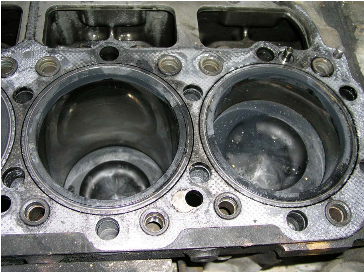
Slika 2. Motor nakon demontirane glave
