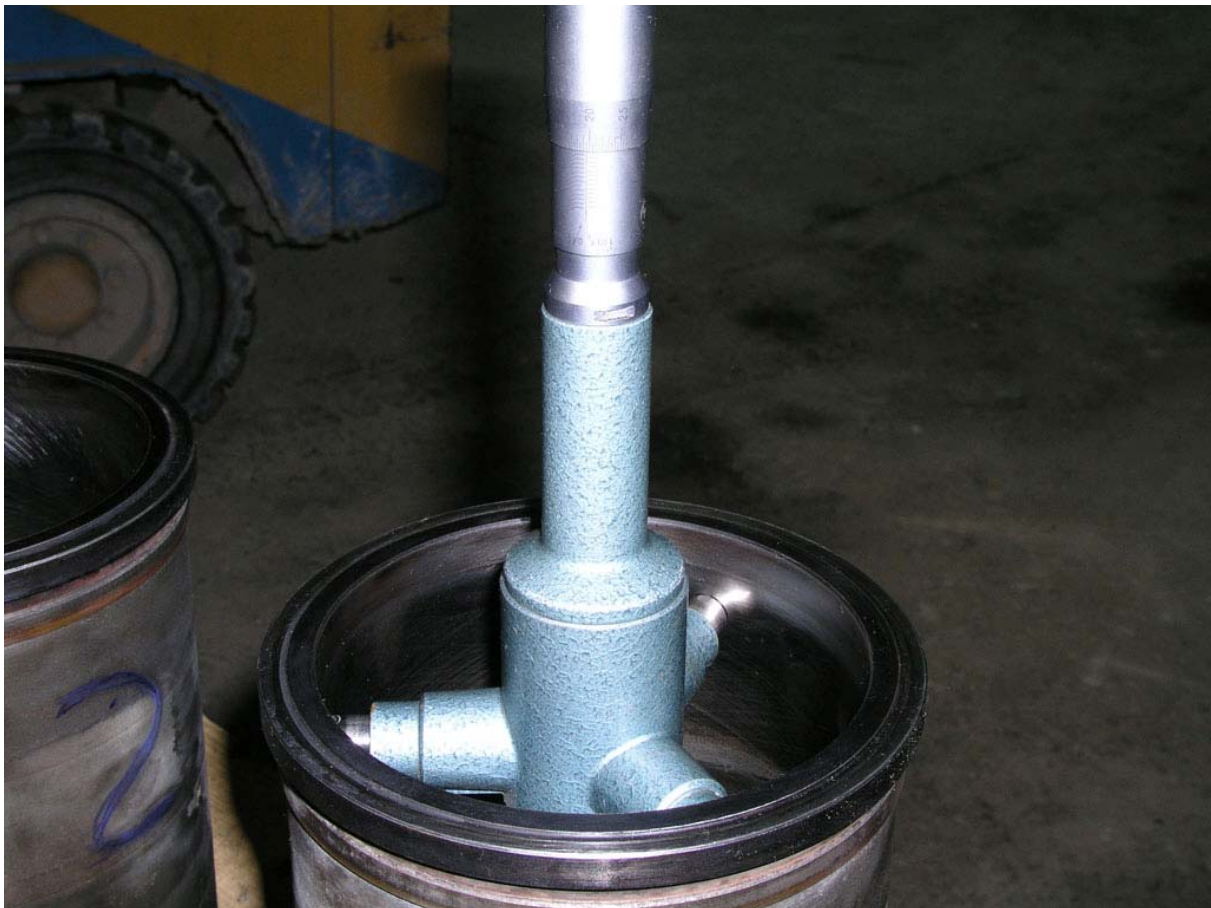
Slika 8. Mjerenje cilindarske košuljice trokrakim mikrometrom
