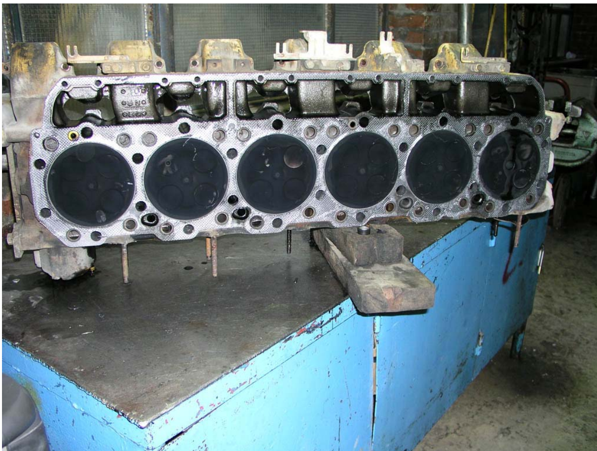
Slika 4. Glava motora nakon demontaže (bez ikakvog čišćenja)
