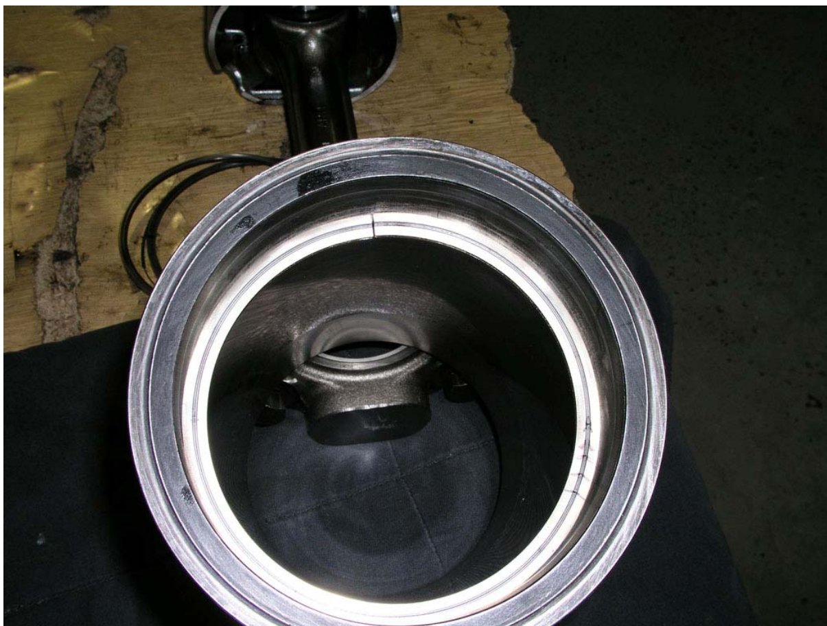
Slika 10. Uljni klipni prsten u cilindru
