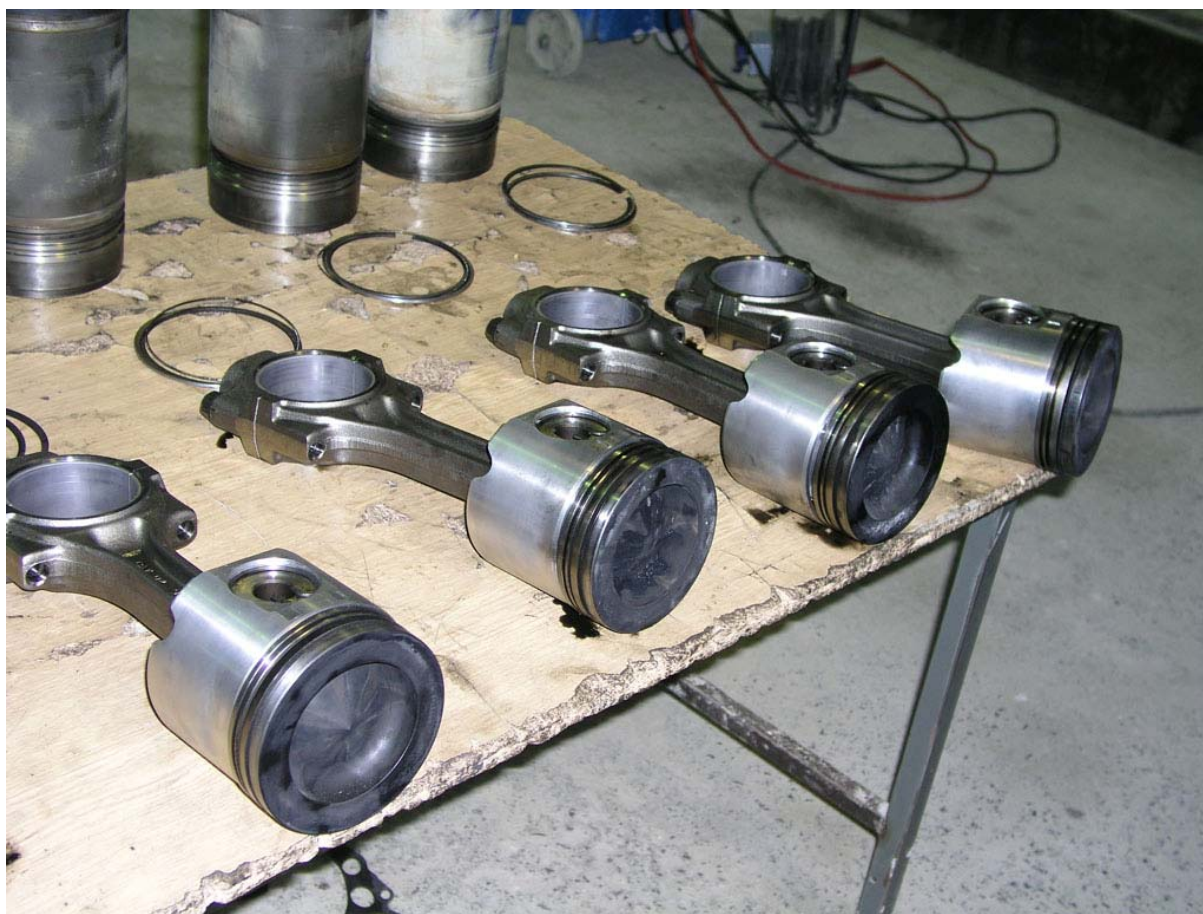
Slika 6. Tek demonitarni klipovi bez ikakvog pranja ili čišćenja.
