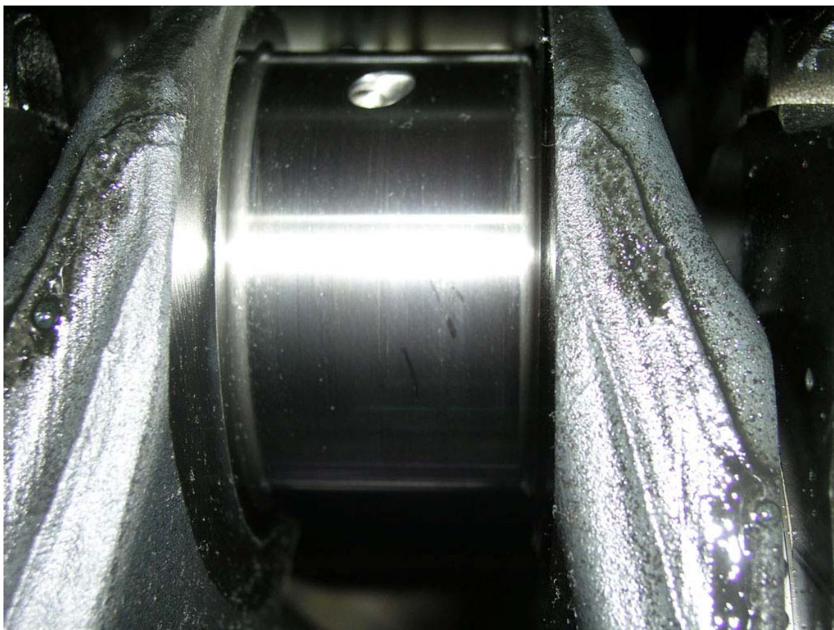
Slika 11. Koljenasto vratilo (radilica motora) - čep letećeg ležaja
