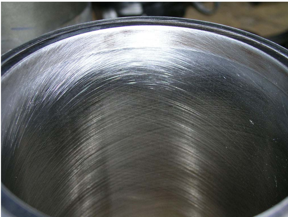
Slika 7. Izgled cilindarske košuljice, na kojoj je blago, brusnim papirom skinut maleni sloj čađi u dijelu kompresionog prostora. Na ostaloj površini se jasno vide tragovi tvorničke strojne obrade
