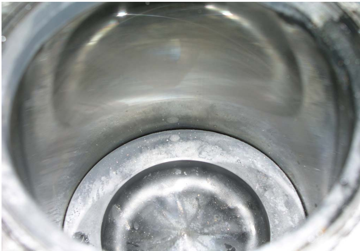
Slika 3. Nedemontiran klip u cilindru
