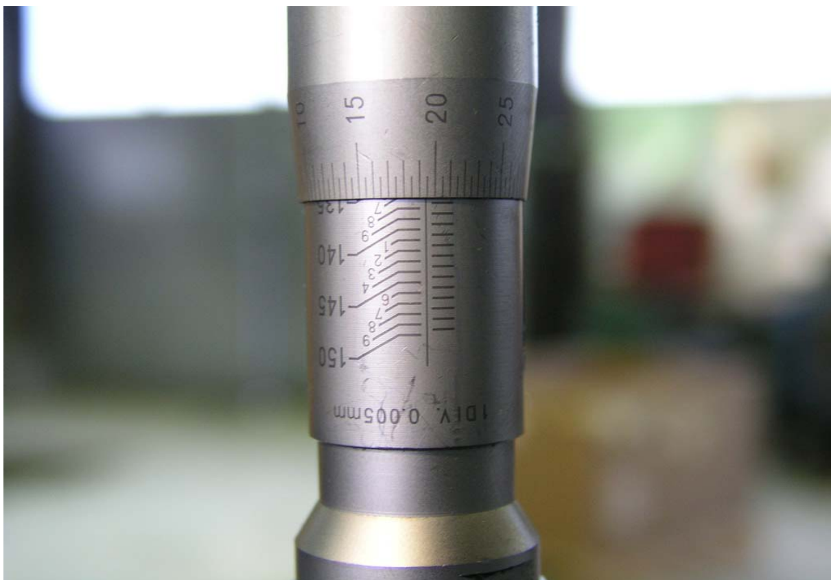
Slika 9. Izmjerene vrijednosti trokrakim mikrometrom
